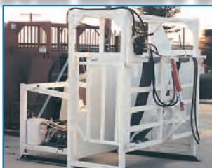
Prensa fija con rotación para el recorte de pezuñas Se puede inclinar hacia la derecha o izquierda
